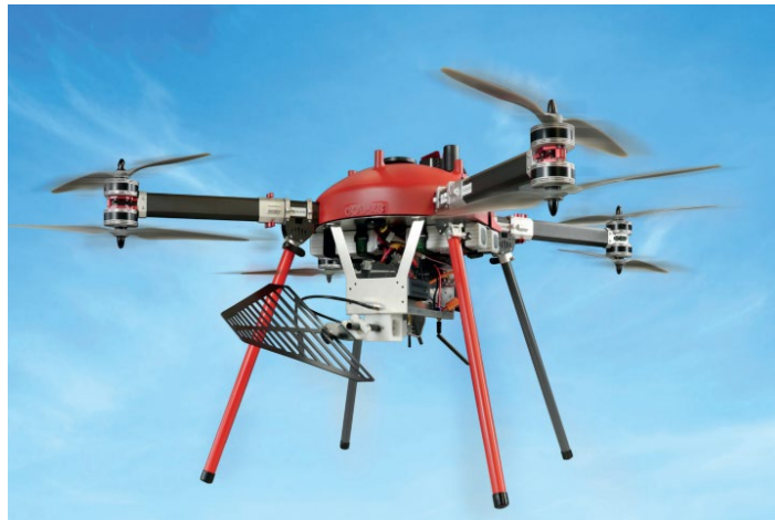
Figura 4.4.3 Dron portando medidor de RF una antena directiva multifrecuencia de ángulo cerrado con posibilidad de orientación vertical u horizontal.
