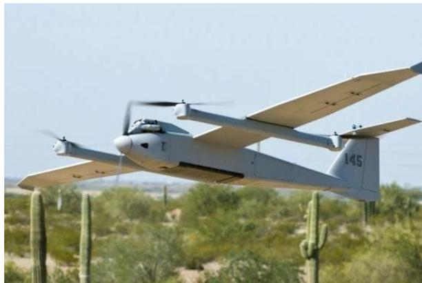
Figura 5. Ala fija de despegue vertical (VTOL).
