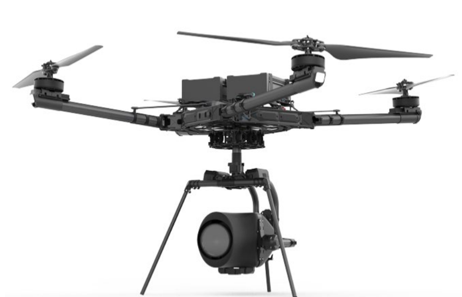
Figura 10. Imagen de opción de MULTIRROTOR en estudio: ALTA X
