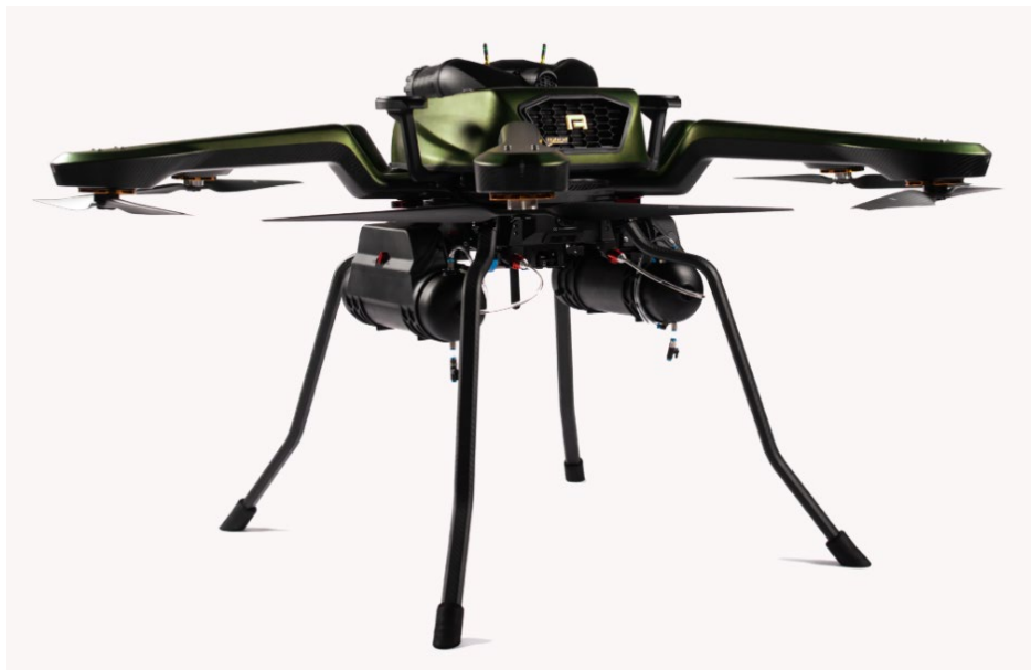
Figura 16. Imagen de opción de MULTIRROTOR en estudio: NOA H6 HYBRID
