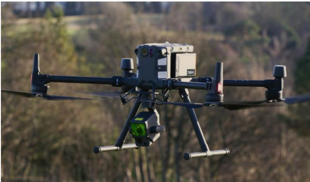
Figura 4. Imagen de opción de MULTIRROTOR en estudio: M300
