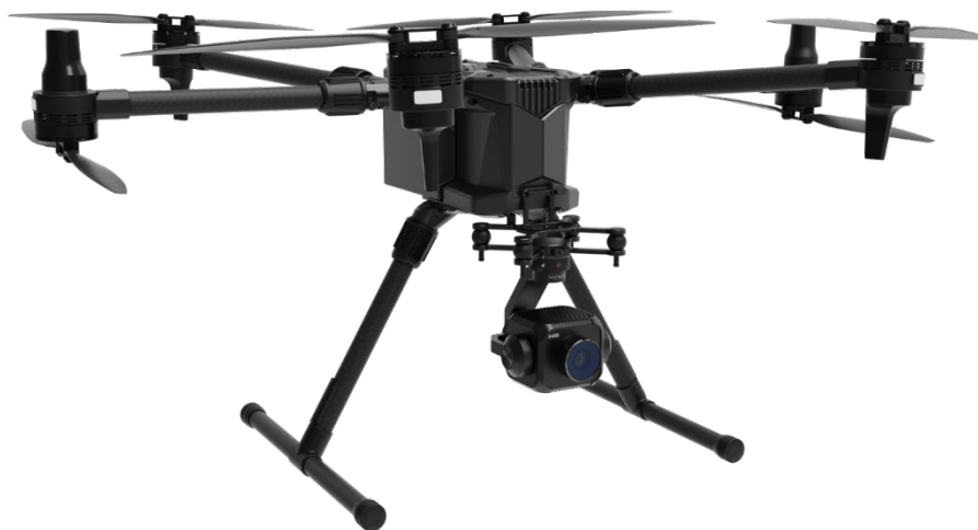
Figura 7. Imagen de opción de MULTIRROTOR en estudio: H850
