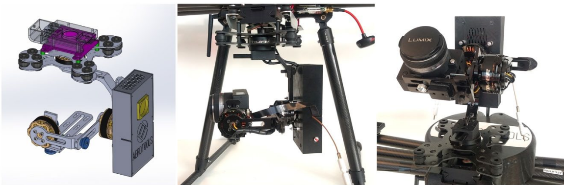
Figura 43. Diseño en 3D, posición inferior y posición superior del gimbal multiposición.
