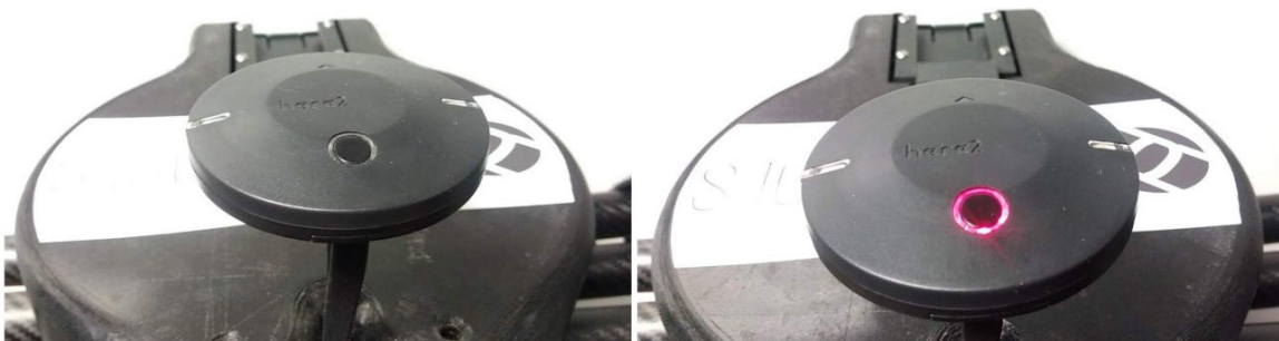
Figura 28. Safety Switch integrado en la caja del GPS de la aeronave.
