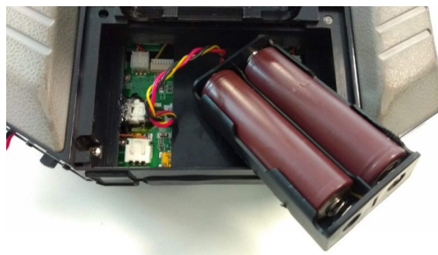
Figura 15. Vista en detalle de la batería de la emisora.
