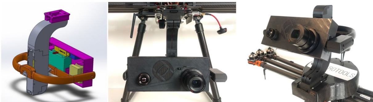
Figura 46. Diseño en 3D, posición inferior y posición superior del gimbal multicámara.
