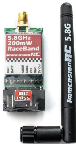
Figura 36. Transmisor de vídeo Immersion RC
