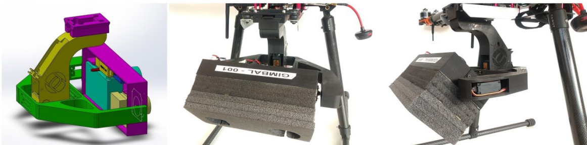
Figura 48. Diseño 3D del gimbal equilibrado con servomotores y embarcado en la aeronave.
