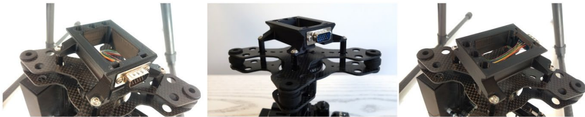
Figura 45. Pieza específica de soporte para gimbal multiposición embarcada en la aeronave.
