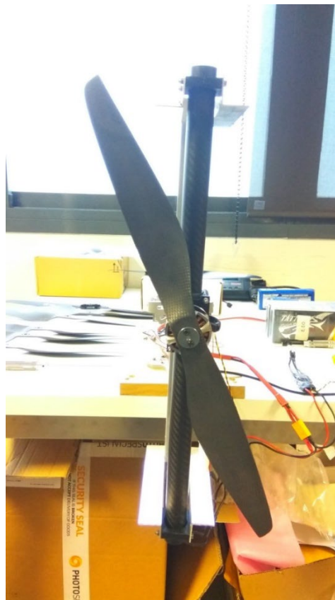
Figura 9. Vista frontal de la configuración del banco de prueba de motores.
