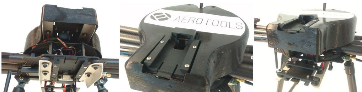
Figura 42. Conector inferior y superior embarcado en la aeronav.
