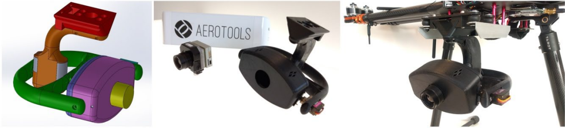
Figura 52. Diseño 3D gimbal cámara térmica y embarcado en la aeronave.
