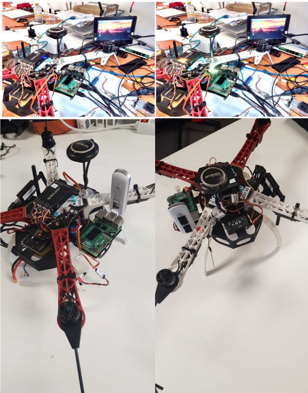
Figura 23 Prueba de Hardware del conjunto Pixhawk, la Raspberry Pi y el dispositivo 4G LTE USB.
